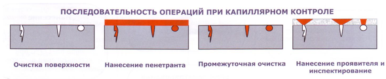
Рисунок 1 - Основные операции при капиллярной дефектоскопии
