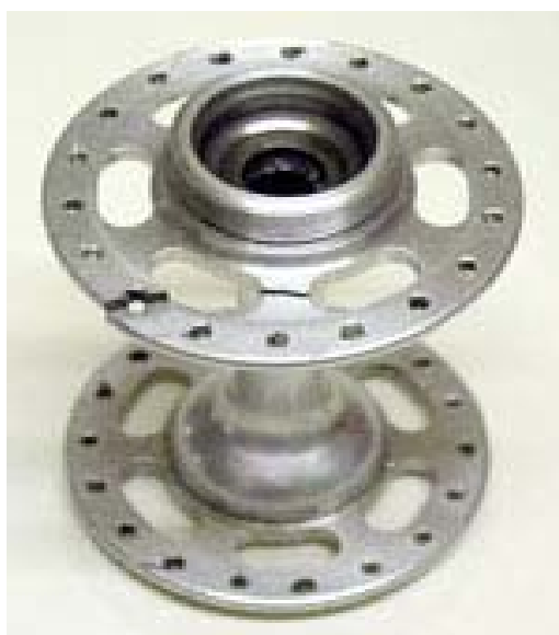
Рис. 1.3. Усталостное разрушение фланца втулки
