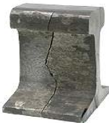
Рис. 1.4. Усталостное разрушение рельса
