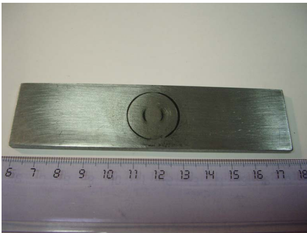
Рис. 4.14. Картина отложения магнитного порошка на контрольном образце для магнитной дефектоскопии с поверхностным и подповерхностным дефектом
