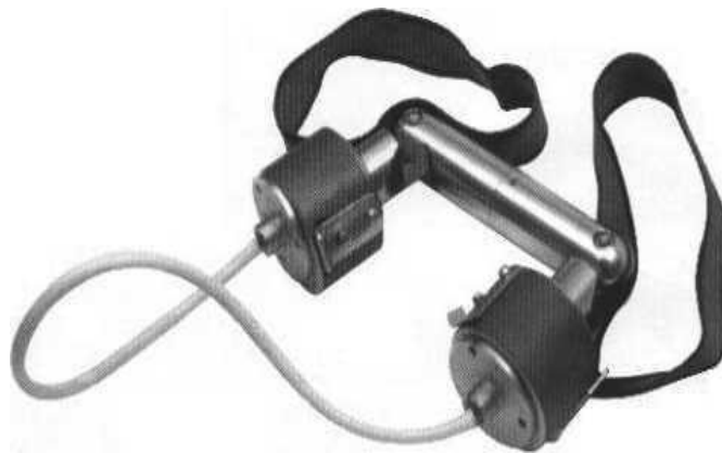
Рис. 3.19. Портативный дефектоскоп на постоянных магнитах МД-4П (МД-4К) для магнитопорошковой дефектоскопии
